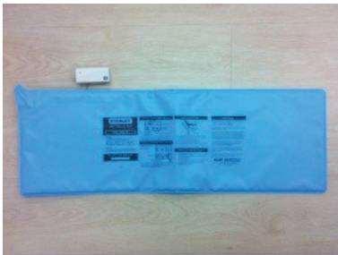
Figura 3. Dispositivo detector de presencia en camas
