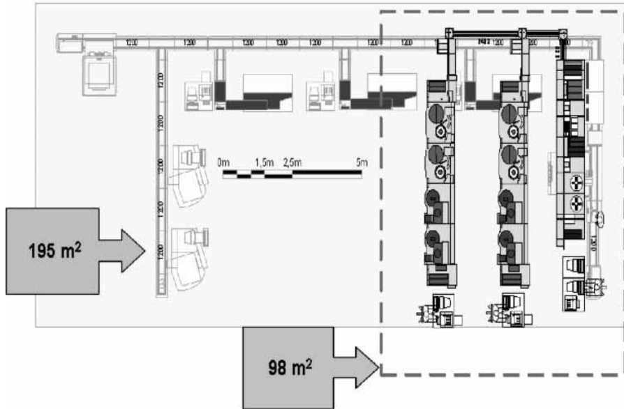
Fig. 5. Ejemplo de reducción de la superficie de trabajo necesaria en un laboratorio automatizado
